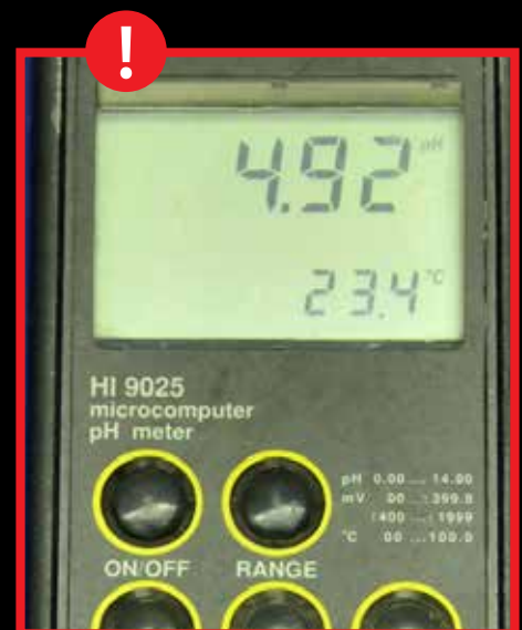
46. pH non conforme (4,92)
